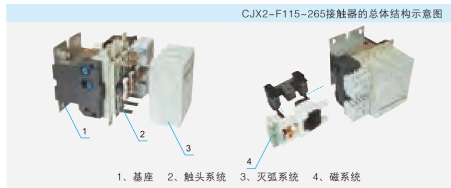
5.1.2 接触器的接触系统为直动式、双断点布置，下基座采用铝合金材质，线圈为塑料封装结构，且线圈与磁轭组成一体，可从接触器中直接取出或装入，使用、维修极为方便；
