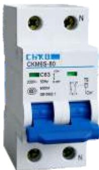
CKM6S-80系列小型断路器（卡式电表专用开关），具有信号欠压延时分励脱扣功能，适用于交流50Hz或60Hz，额定工作电压230/400V，额定电流至80A的线路中，对线路进行远距离控制分断或自动信号控制分断，同时对线路起过载和短路保护作用，也可以作为线路的不频繁操作转换之用。目前广泛应用于与IC卡预付费电度表配套使用来控制线路的通断。
